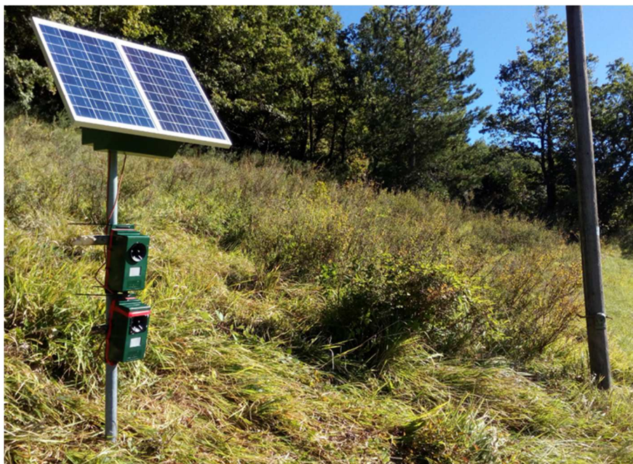
Figura 150 – Dissuasori ad ultrasuoni accoppiati a video-foto-trappola (sul palo) nel sito di sperimentazione
