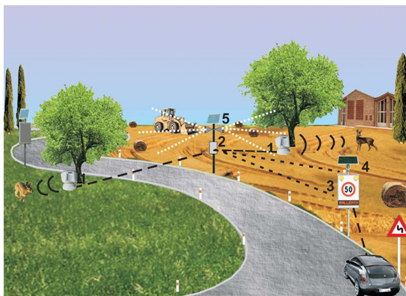
Figura 153 – Schema di funzionamento del sistema di prevenzione sviluppato nell'ambito del progetto Life Strade (tratto da: lifestrade-prevenzione )
